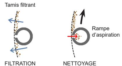
**Evacuation.** Lors du nettoyage, une électrovanne s'ouvre et les matières en suspension sont évacuées en dehors du filtre.
