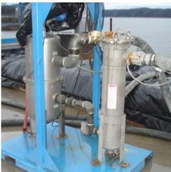
**Eaux de surface.** Les eaux de lacs et rivières contiennent des matières particulièrement colmatantes, ce qui nécessite d'avoir un système de nettoyage performant. Les filtres Hectron peuvent fonctionner avec des eaux à forte concentration en matières.
