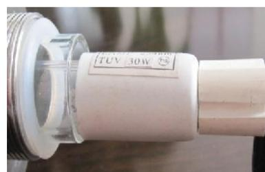
Placer le connecteur 4 broches femelles en face des 4 broches de la lampe et poussez doucement afin d'établir la connexion et resserrez l'écrou.
