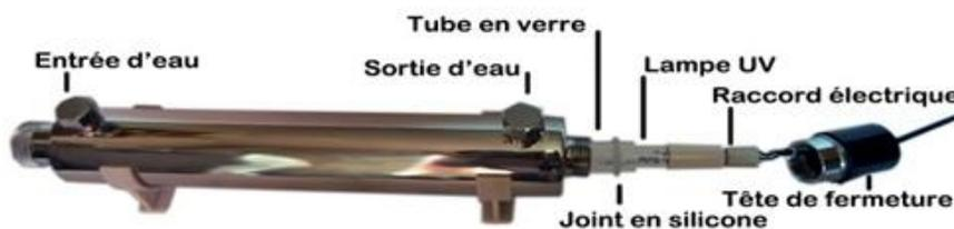
Placez dans le réacteur en Inox le tube en verre (Quartz), autour duquel on met les 2 joints fournis à chacune des extrémités (voir photos ci-dessous). Pour plus de facilité et pour éviter la casse du quartz placez le stérilisateur verticalement et le tenant entre vos genoux. Laissez glisser le tube de quartz doucement jusqu'au fond, vous devez voir l'extrémité arrondie du quartz, ensuite remettez l'écrou en place.
