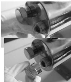
**Étape 8 :** Vissez à la main l'écrou d'extrémité ouverte sur la chambre du réacteur (côté ouvert du tube en quartz). Pour protéger le joint torique, évitez de trop serrer.
