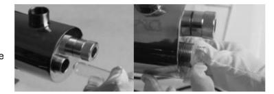
**Étape 6 :** Installez le joint torique sur l'extrémité fermée du tube en quartz.
