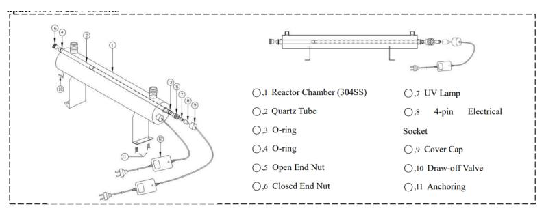
**Étape 1 :** Ouvrez l'emballage pour vérifier tous les composants à l'intérieur : Chambre du réacteur, lampe UV, tube en quartz, joints toriques, ballast électronique.
