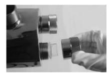
**Étape 9 :** Connectez solidement la prise électrique à 4 broches avec les broches de la lampe UV.
